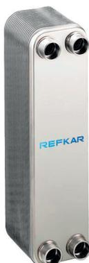
Серия KB представляет собой модернизированную версию серии В. Она была разработана специально для систем с R410A. Её эффективность теплопередачи на 10% выше, чем у серии В. Кроме того, серия KB полностью подходит в тех случаях, когда перепад давления не является основной проблемой.
